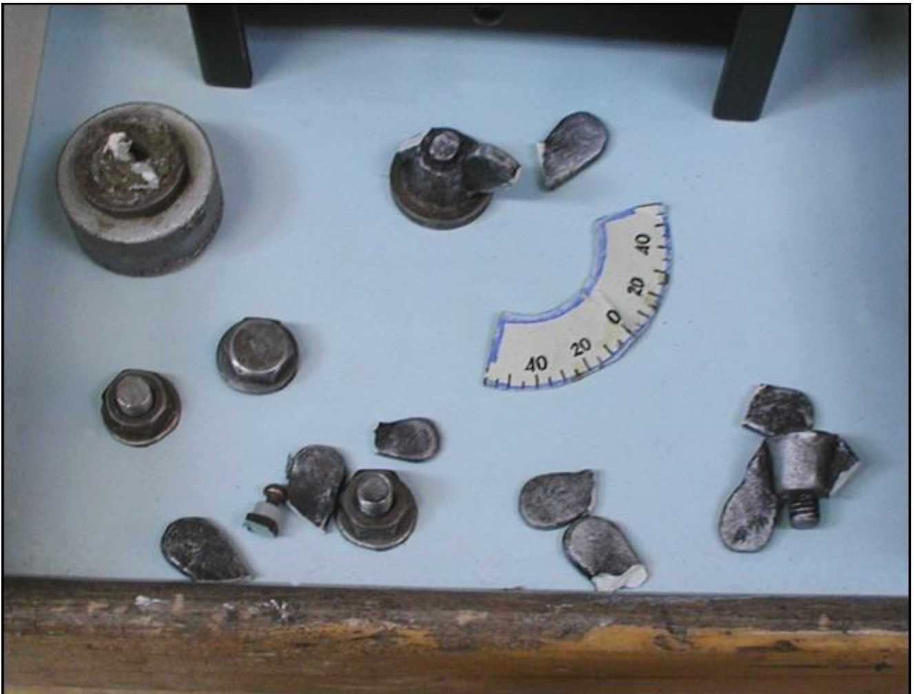
Обломанные гипсовые уши барашков, головки болтов и вертикальная шкала от большого конуса.
